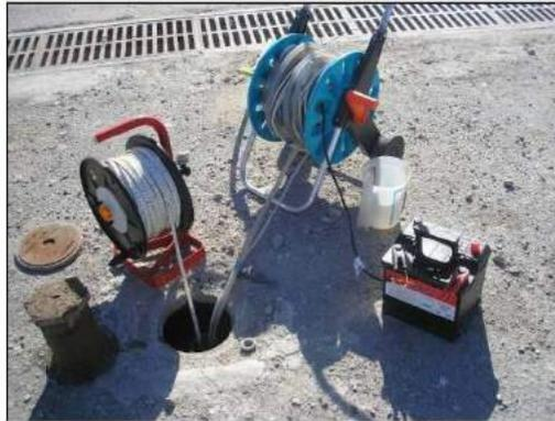
Photo 1 : Matériel de prélèvement des eaux souterraines
